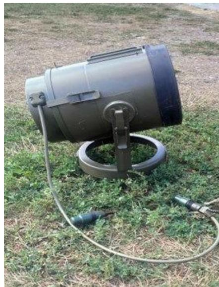
**ЗАСТЕРЕЖЕННЯ:** Міна протитанкова, протибортова. Враження цілі наноситься в бокову проекцію дією ударного ядра. Приводиться в дію по лінії керування або за допомогою обривного датчика цілі.
