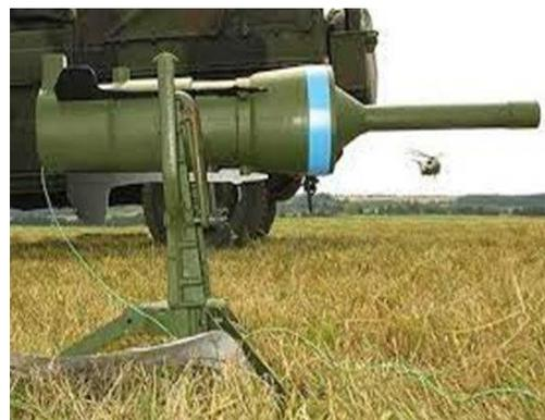
**ЗАСТЕРЕЖЕННЯ:** Міна протитанкова, протибортова. Враження цілі наноситься в бокову проекцію. Приводиться в дію за допомогою світловоду (оптоволоконного кабелю).
