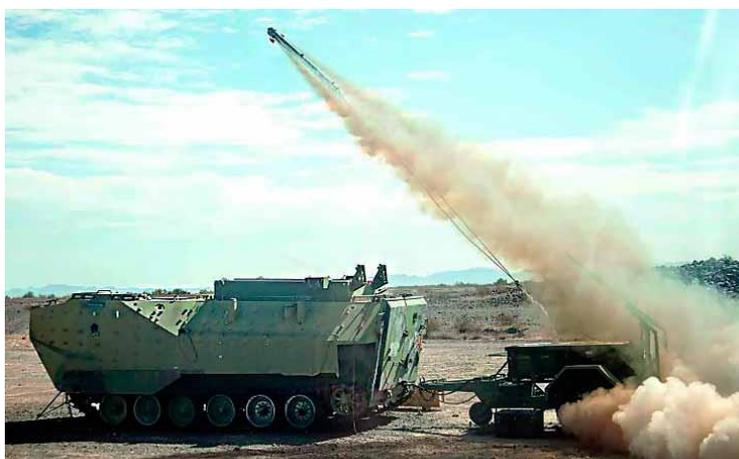
Пуск заряду проводиться командиром інженерного відділення з кабіни транспортної машини через кабельне з'єднання або після від'єднання причепа і відведення транспортного засобу в укриття з переносного пульта керування з відстані не менше 100 метрів. Після вироблення палива ракети відбувається автоматичне від'єднання заряду від неї та падіння на мінне поле. Вибух заряду відбувається автоматично.
