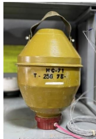
Міна виконана в корпусі конічної форми, в який залитий плавлений тротил та оснащена механічним штирьовим підривником, який закріплюється на виносній опорі. Міна встановлюється вручну в ґрунт таким чином, щоб при наїзді цілі на штир підривника вона знаходилася під серединою днища машини. Ініціювання заряду відбувається через 0,2 - 0,4 сек після впливу цілі на штир.
