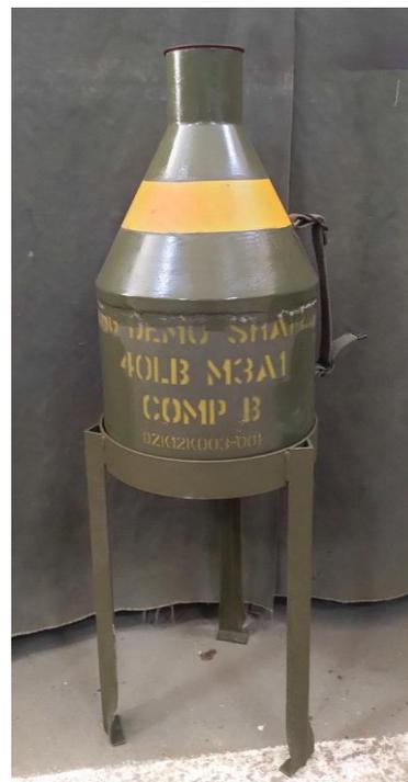
**ЗАСТЕРЕЖЕННЯ.** Кумулятивний заряд промислового виготовлення вибухає від капсуля-детонатора. Може приводитись в дію вогневим ( запалювальна трубка, запалювальна трубка з відрізком ДШ) та електричним (електродетонатор з відрізком саперного проводу або електродетонатор з відрізком ДШ) способами.
