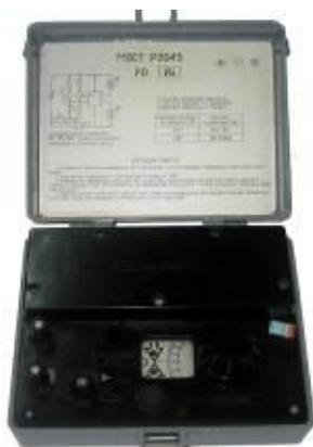
Лінійний міст P-3043 призначений для вимірювання опору електродетонаторів і електровибухових мереж. Міст призначений для роботи в польових умовах, а також в шахтах небезпечних по газу та пилу і має виконання P0/ I, що досягається використанням безпечного джерела живлення і відсутністю індуктивних елементів.
