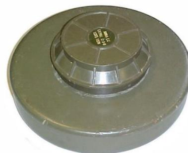
**ЗАСТЕРЕЖЕННЯ:** Міна протигусенична вибухає при достатньому тиску (145кгс) на підривник міни, що спричиняє протискування підривника та подальше спрацювання міни.
